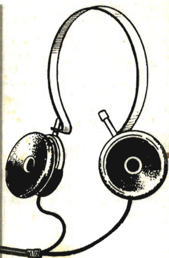
Fig. 5 - L'impiego di una pila e di una normale cuffia permettono di rivelare, empiricamente, corto-circuiti e interruzioni dei condensatori.
