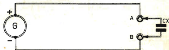
Fig. 6 - L'esame di un condensatore risulta veramente efficace quando il suo valore capacitivo è dell'ordine dei 100.000 pF e quando si dispone di una tensione di prova relativamente elevata.
